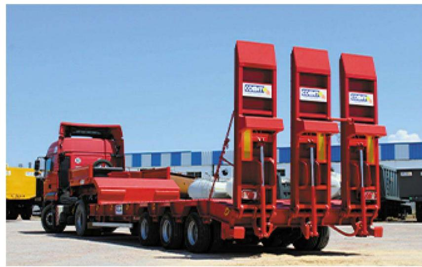
Semi-remorque Porte-Engins moyen tonnage à 3 Rampes
